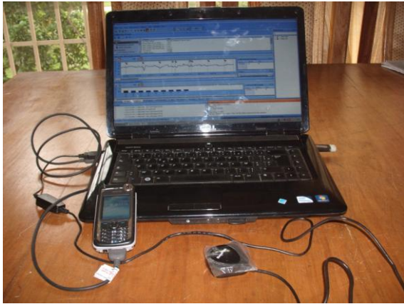
Outils de Drive Test Nemo Outdoor : Portatif Nemo, antenne extérieur &GPS, Onduleur, PC, Chargeur, etc.
